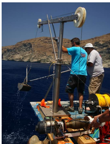
Εικόνα 4.1.6.1.: Ο δειγματολήπτης τύπου Van-Veen Hydro-Bios που χρησιμοποιήθηκε για τη συλλογή επιφανειακών δειγμάτων ιζήματος
