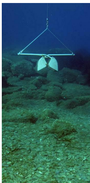
Εικόνα 4.1.6.1.: Ο δειγματολήπτης τύπου Van-Veen Hydro-Bios που χρησιμοποιήθηκε για τη συλλογή επιφανειακών δειγμάτων ιζήματος
