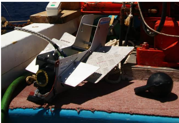
Εικόνα 4.1.5.2: Η αυτοσχέδια υποβρύχια συρόμενη κάμερα.
