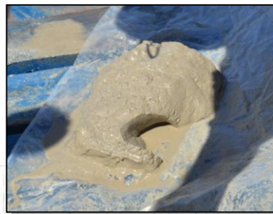
Εικόνα 5.2.12: Χαρακτηριστική τομογραφία και δείγμα ιζήματος για τον τύπο πυθμένα «Λεπτόκοκκη άμμος/αμμοϊλός».
